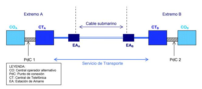
En el caso del servicio de líneas alquiladas troncales submarinas, el servicio consta de tres partes: dos Puntos de Conexión, uno en cada extremo, entre el operador y Telefónica; y el servicio de transporte, que incluye la capacidad en el cable submarino y un tramo terrestre que discurre desde la estación de amarre hasta la central frontera de Telefónica a la que está conectado el operador.
