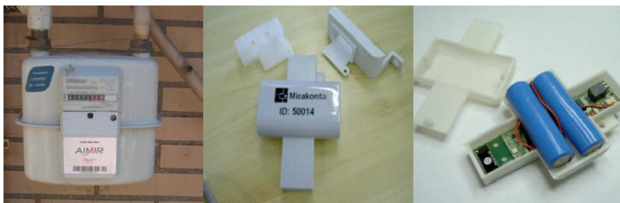
Ilustración 3. Componentes del Retrofit kit, instalado en un contador de gas actual
