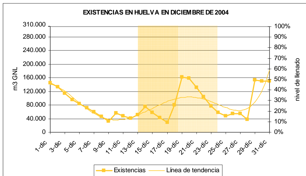
Figura 22. Existencias en planta de Huelva. Fuente: ENAGAS.
