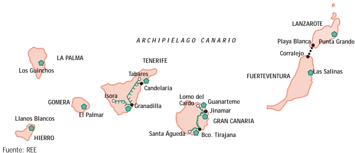
Figura 3.2.40. Conexiones eléctricas en Canarias
