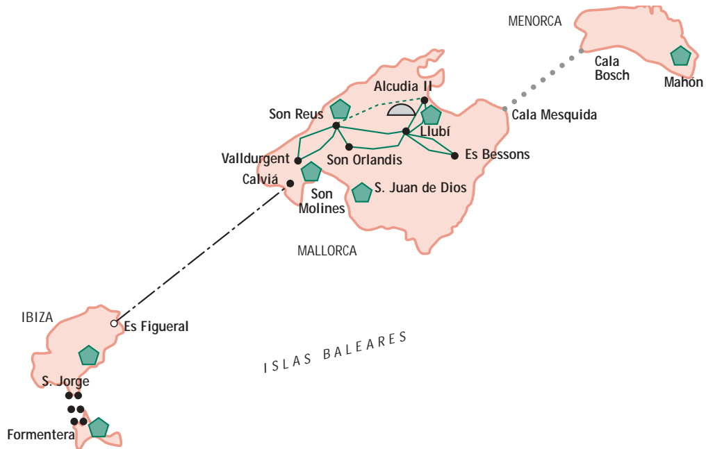
Figura 3.2.38. Conexiones eléctricas en Baleares
