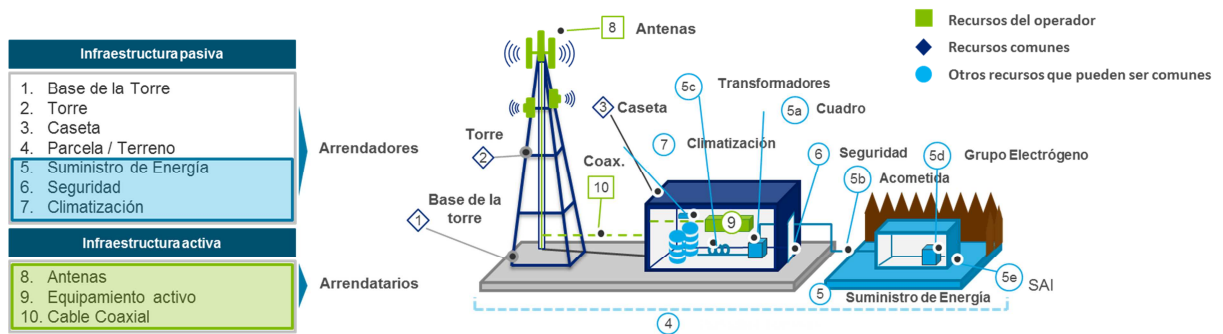
Figura 97.- Infraestructura típica incluida en la venta de torres por parte de Operadoras de telecomunicaciones
