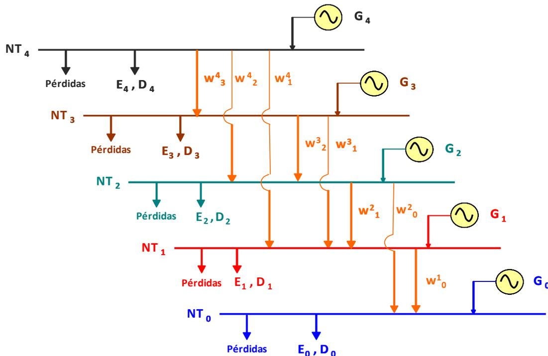
En dicho modelo de red existen cinco niveles de tensión tarifarios: NT<sub>0</sub> (menor que 1 kV), NT<sub>1</sub> (tensiones superiores a 1 kV e inferiores a 30 kV), NT<sub>2</sub> (tensiones superiores a 30 kV e inferiores a 72,5 kV), NT<sub>3</sub> (tensiones superiores a 72,5 kV e inferiores a 145 kV) y NT<sub>4</sub> (tensiones superiores a 145 kV). Las variables presentadas en el modelo son las siguientes:
