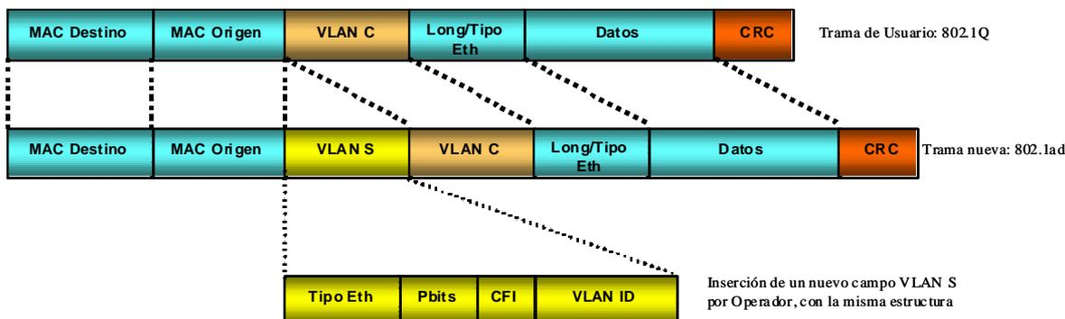
Así en el LAGL, al Operador se le entregará con la S-VLAN el tráfico de todas las conexiones NEBA LOCAL de ese Operador que se cursa desde una determinada OLT (o determinada tarjeta de línea de la OLT, como ya se ha descrito) y ese LAGL, diferenciando por la C-VLAN el tráfico generado por cada una de las conexiones NEBA LOCAL de ese Operador que hay en la OLT, preservándose el valor de los bits de prioridad 802.1p de la etiqueta C-VLAN que la OLT presente en las tramas Ethernet.
