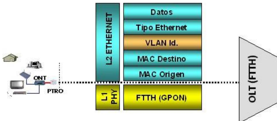
Figura 1: Estructura de protocolos para conexiones FTTH
