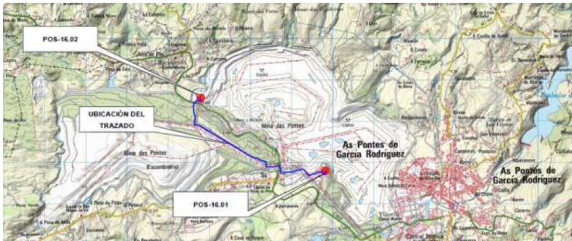
El proyecto incluye las instalaciones relativas a la posición 16.01 de salida del hidrogenoducto de la planta de producción de hidrógeno de H2POLE, ubicada dentro de los límites de la propia planta y las instalaciones ligadas a la posición 16.02 de llegada del hidrogenoducto a la futura factoría de producción de neumáticos de Sentury Tire, incluyendo una estación de medida y el sistema de alimentación eléctrica.
