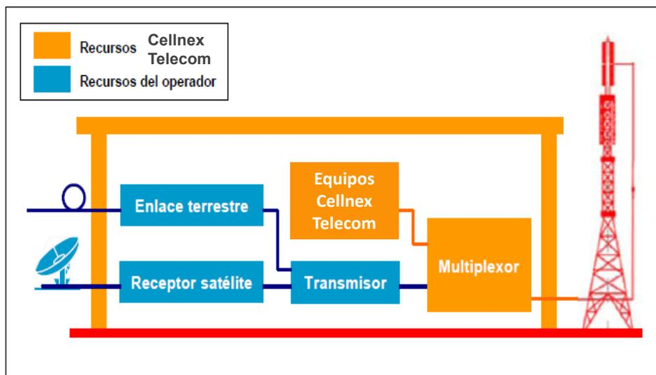
Figura 2. Esquema general de la modalidad de interconexión
